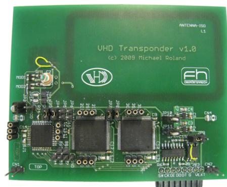
Abbildung 6.3: Transponder mit Datenspeicher
